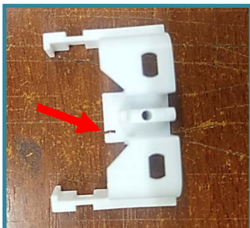
На фиксаторе веревки сделать пропил 3 мм
