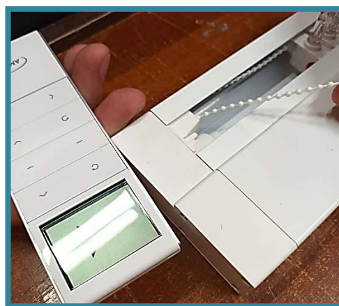
С пульта повернуть шестерёнку пока конец цепи не выйдет из левого отв-я
